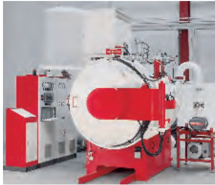
Die neu beschaffte Vakuum-Kammerofenanlage ermöglicht, Wärmebehandlungs- und Fügeprozesse unter Vakuum durchzuführen.
