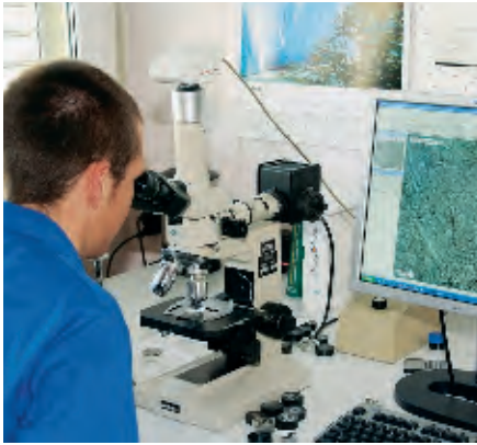
Im hauseigenen Labor werden Materialanalysen und Gefügebilder erstellt sowie Einsatz- und Nitrierhärtetiefen kontrolliert.
