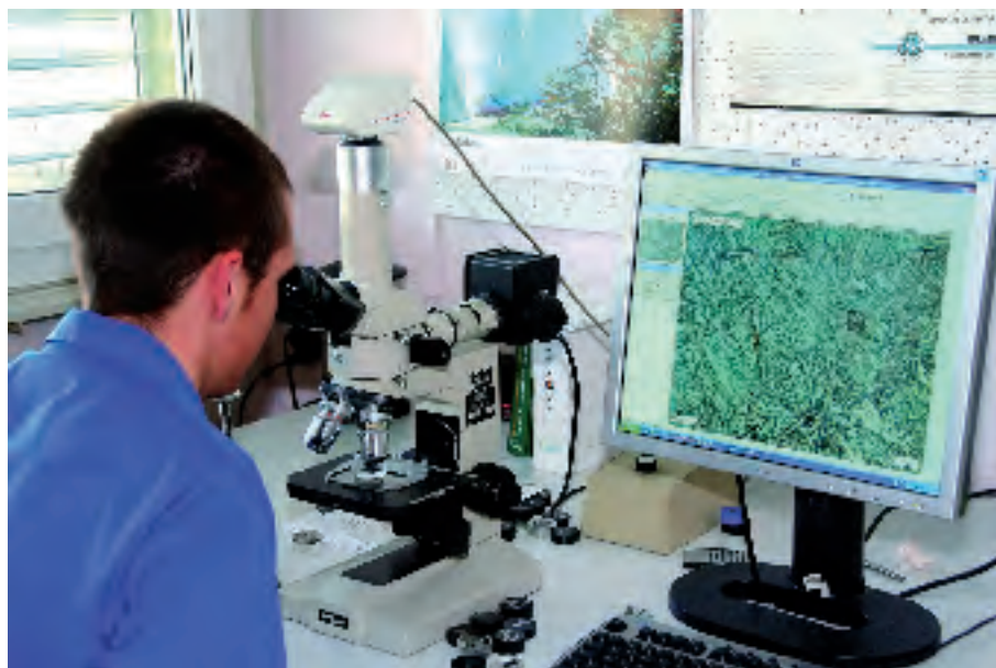
La métallographie a une grande importance pour détecter les éventuels défauts à l'intérieur de la matière ou encore pour observer la profondeur des traitements thermiques effectués.
