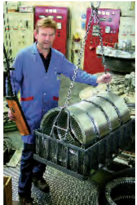
Manutention de pièces après traitement.
