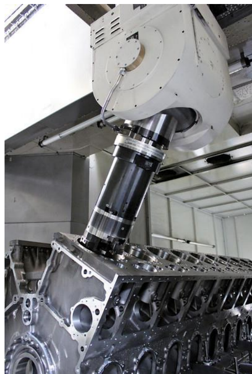
Fertigen der Zylinderbohrung
